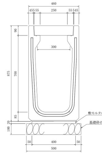
U型側溝 構造図 S=1:10
