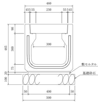
U型側溝 構造図 S=1:10
