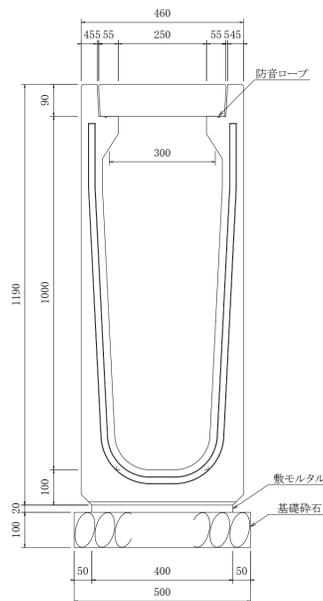
U型側溝 構造図 S=1:10
