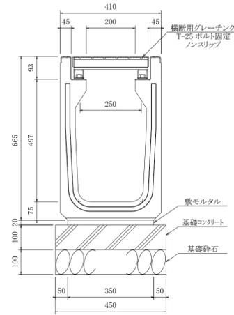
U型側溝 構造図 S=1:10
