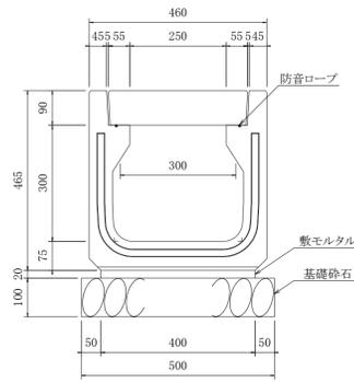
U型側溝 構造図 S=1:10
