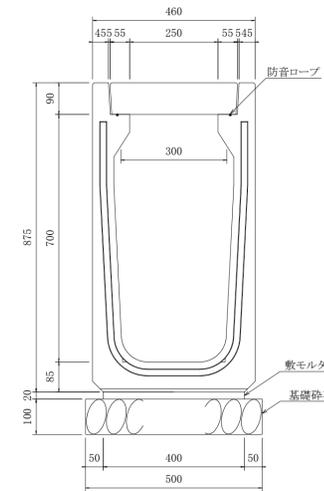
U型側溝 構造図 S=1:10
