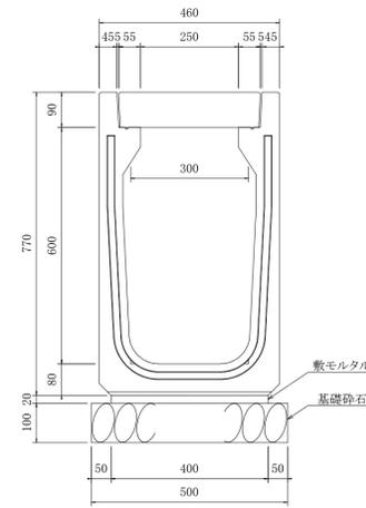
U型側溝 構造図 S=1:10
