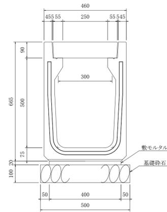
U型側溝 構造図 S=1:10
