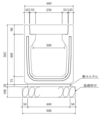
U型側溝 構造図 S=1:10
