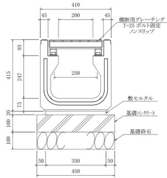
U型側溝 構造図 S=1:10
