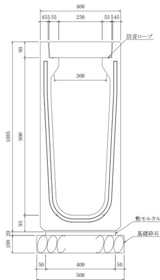
U型側溝 構造図 S=1:10
