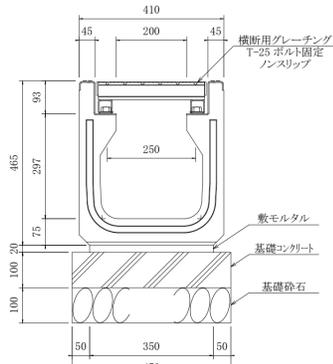
U型側溝 構造図 S=1:10
