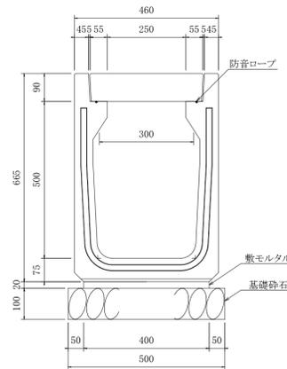
U型側溝 構造図 S=1:10
