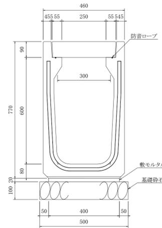
U型側溝 構造図 S=1:10
