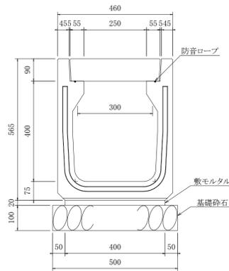
U型側溝 構造図 S=1:10
