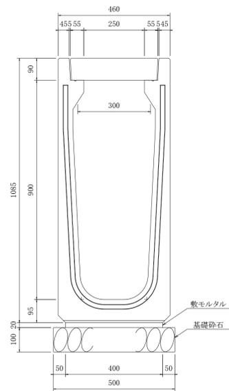
U型側溝 構造図 S=1:10
