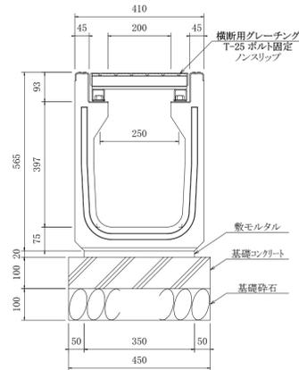
U型側溝 構造図 S=1:10
