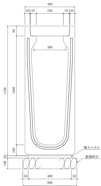
U型側溝 構造図 S=1:10
